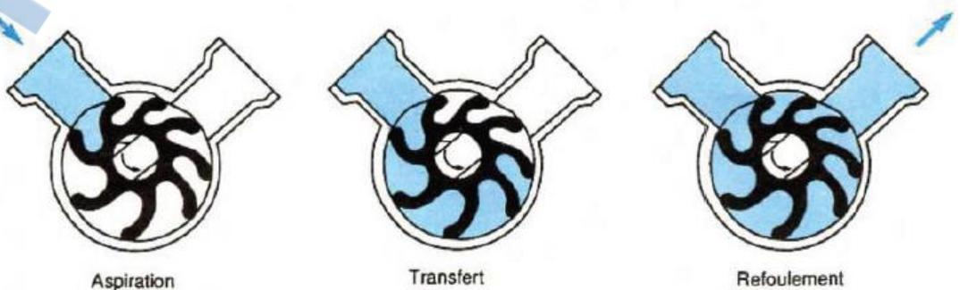
Fig. 1.7. Pompe à palettes flexibles
