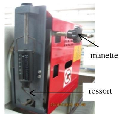
Fig. 4.10. Position du dynamomètre
