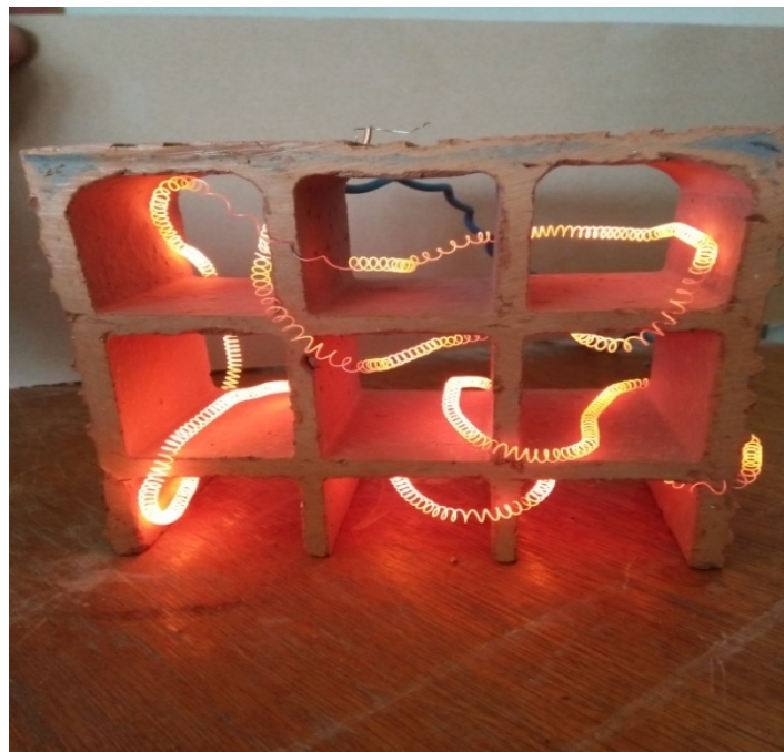
Fig. III.20. Résistance avec brique
