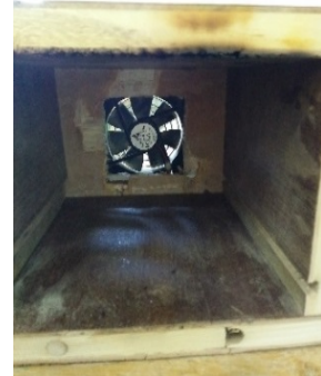
Fig. III.7. Ventilateur et son support en bois pour la circulation d'air.
