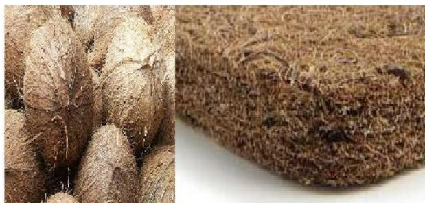
**Figure II.11 : fibre de coco (sources : CARMA, 2010 et FEDULLO, 2011)**
