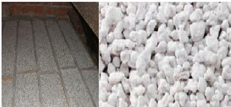
**Figure II.8 : Perlite (sources: REME, 2010 et LEVY, 2014)**
