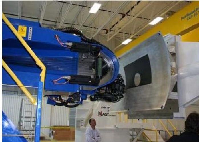
Fig. 2. 9 Tête de placement de machine AFP (Marouene, 2015)
