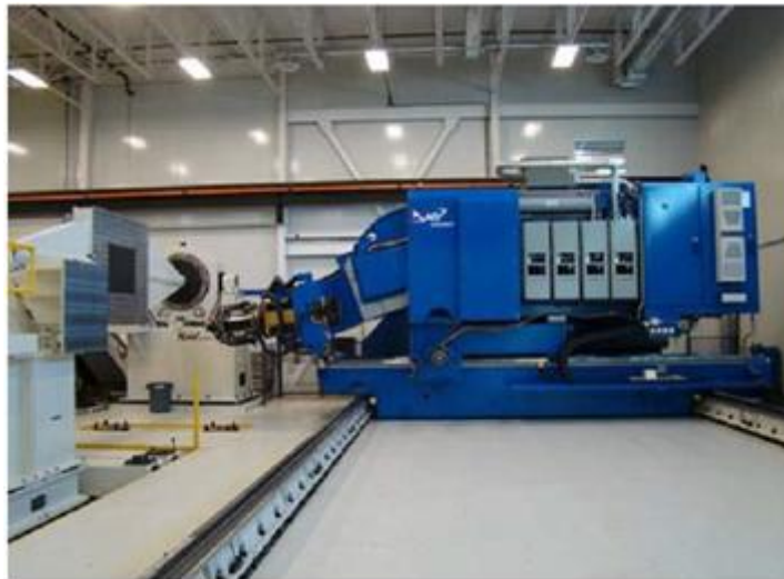
Fig. 2. 8 Machine de placement automatisé des fibres (AFP)
