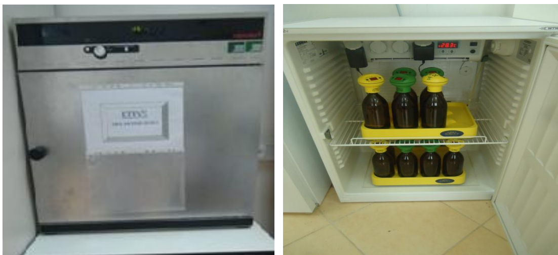
Figure 15: étuve séchoir et incubateur pour DBO
