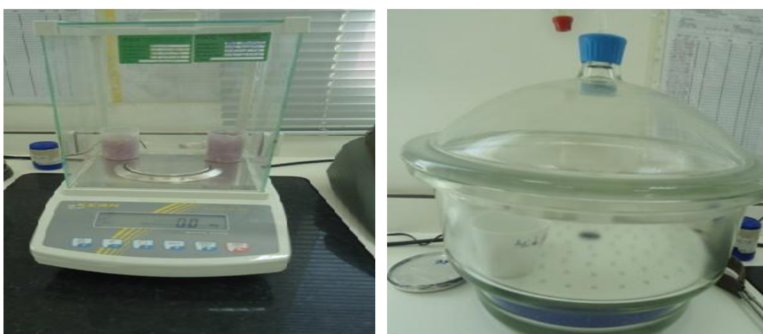
Figure 16: Balance de précision et dessiccateur
