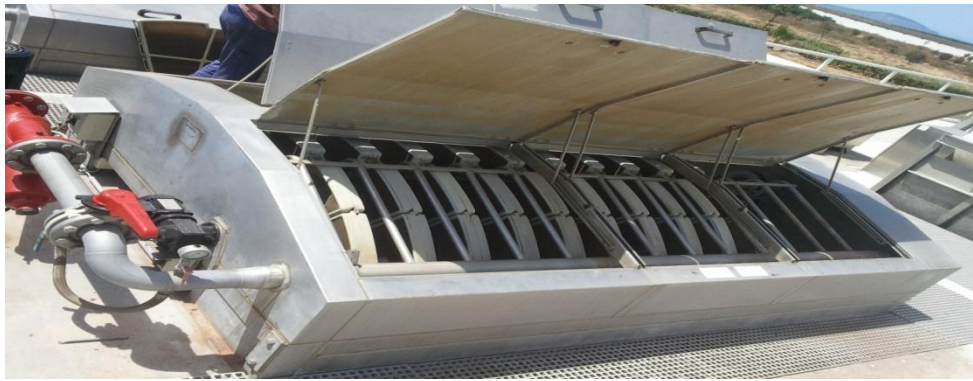
Figure 9:Micros tamis (vue à l'intérieur)
