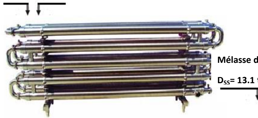
Figure 20 : Débit d'entrée et de sortie du stérilisateur
