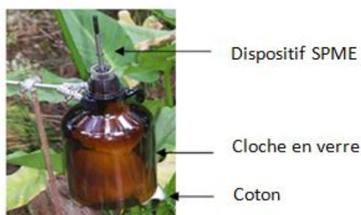
**Figure 23:** Dispositif expérimental mis en place pour les fruits in situ
