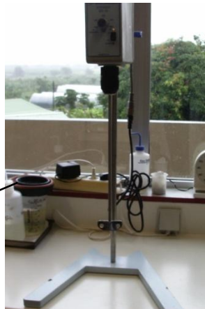
Mélange à l'aide d'un vibromélangeur
