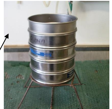
Passage de l'échantillon à travers une colonne de cinq tamis.
