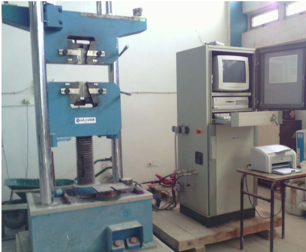
Figure II.1 : Machine 600 KN pour d'essai de traction
