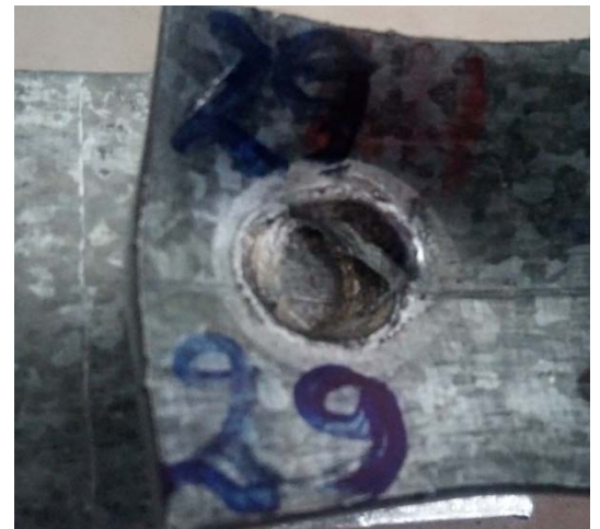
Figure III.8.a. Effet de l'intensité de soudage sur le comportement mécanique de l'assemblage soudé pour une charge de 6.5 KA et un temps de 35 cycles .
