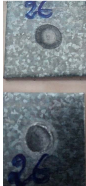
Figure III.12.a : Effet de temps de soudage sur le comportement mécanique de l'assemblage soudé pour une charge de 6 bars et une intensité de 15 KA .
