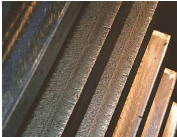
Figure 3.8 : Grippage couvrant l'ensemble des dents [31].
