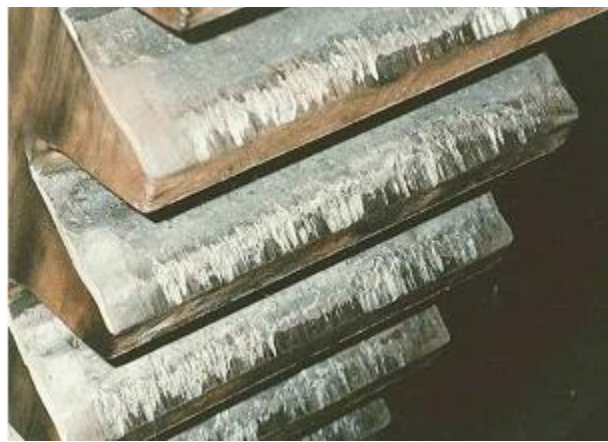
Figure 3.12 : Grippage localisé sur les têtes de dent [31]
