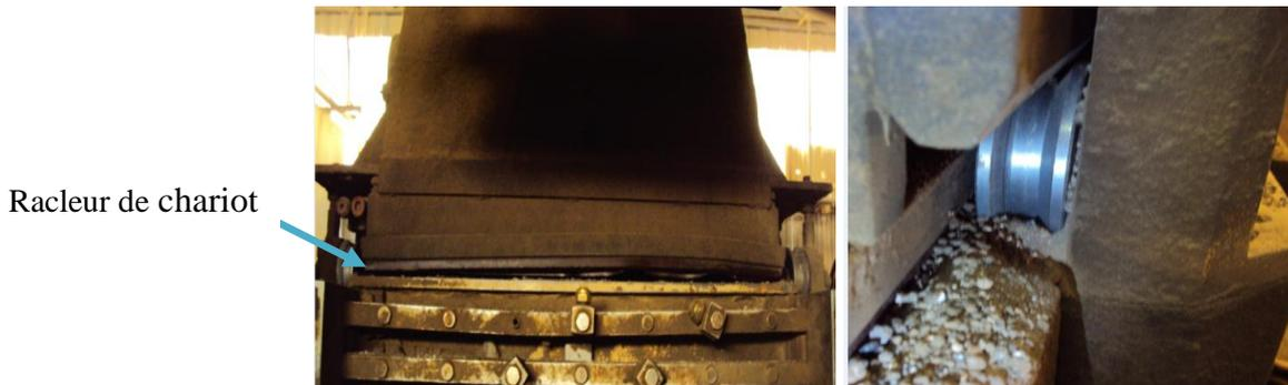
**Figure 3.7. Blocage complet de poulie (chariot)**
