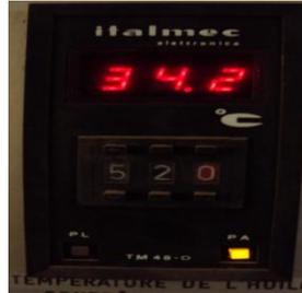
Figure 2.14. L'indicateur de température de fonctionnement
