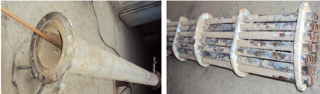
**Figure 3.9. Bouchage de l'échangeur de chaleur**
