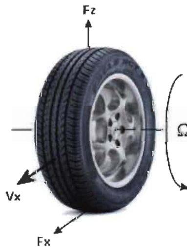
Figure 2.5 Forces appliquées sur la roue en contact avec le sol et en mouvement [39]
