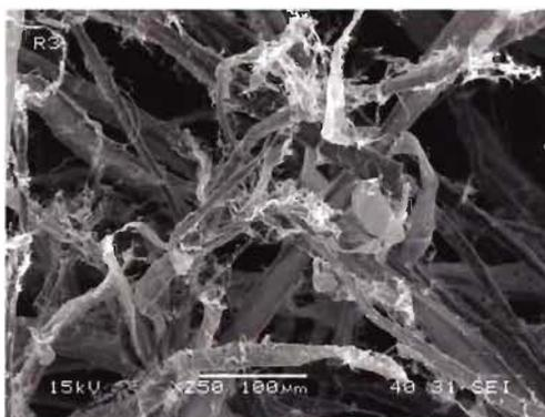
**Figure 3-4 Pâte NBSK R<sub>3</sub> raffinée 45 min – CSF 500 mL**
