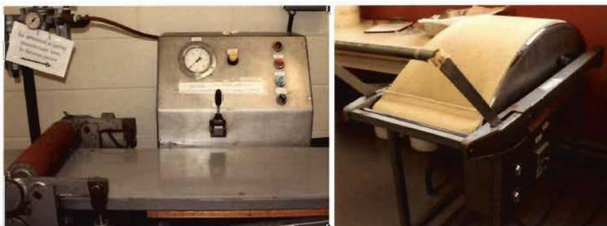
**Figure A-6-1 Presse et séchoir de laboratoire**
