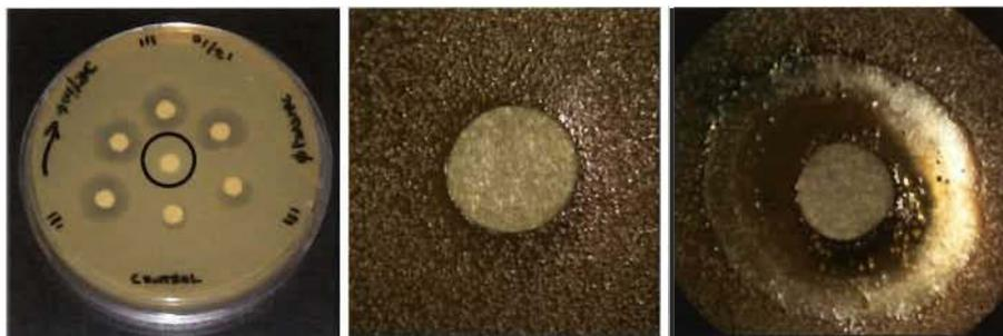
Figure 5-15 Réactivation des papiers bioactifs après leur remouillage
