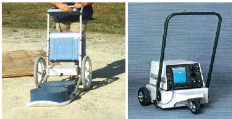
Figure I.5 : Deux exemples de GPR
