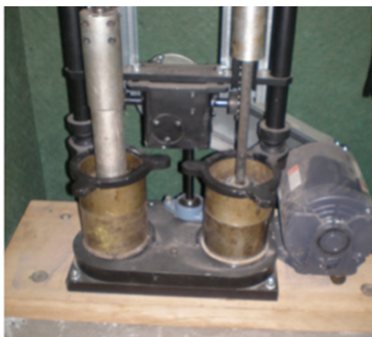
Figure 2.5 Marteau Marshall pour le compactage des échantillons. LCMB, 2012
