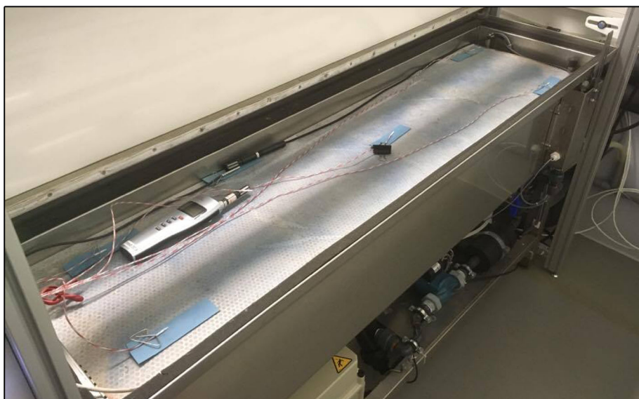
Sondes étalonnées pour le contrôle thermique spatial et temporel des bancs Banc n°2
