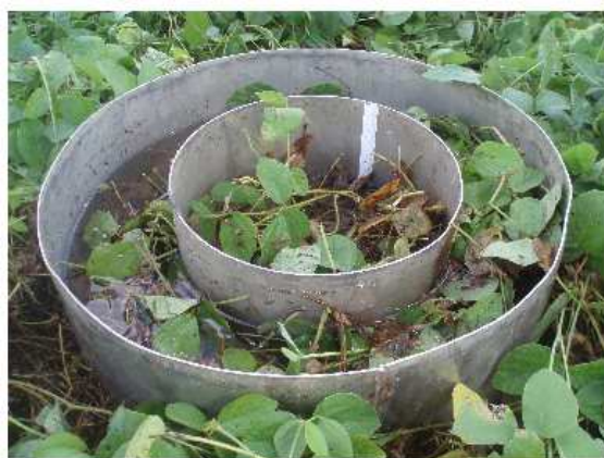
Photo 3 : Infiltromètre à doubles anneaux
