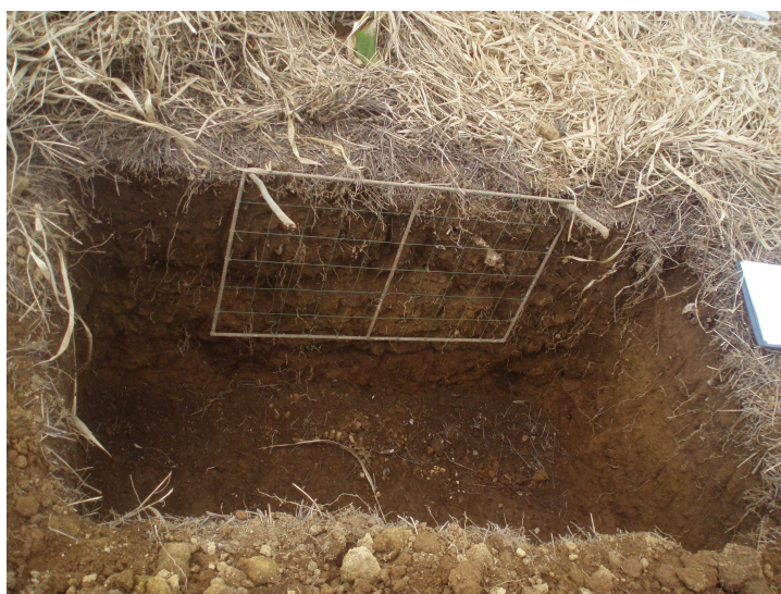
Photo 2 : Fosse et grille permettant la description des sols sur une parcelle élémentaire
