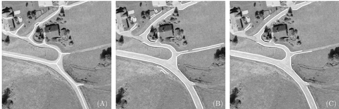
Figure 2.12 : (A) le résultat de l'extraction de l'axe central de la route, (B) l'extraction des bords de la route, (C) le résultat final de l'extraction.
