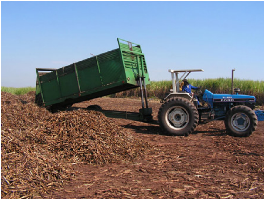
Système mécanique A : déversement de la canne tronçonnée en vrac sur la loading zone.
