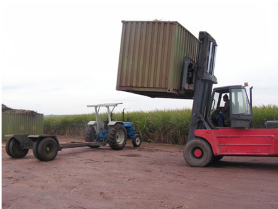
Système mécanique B : stockage de la canne dans des containers sur la loading zone.
