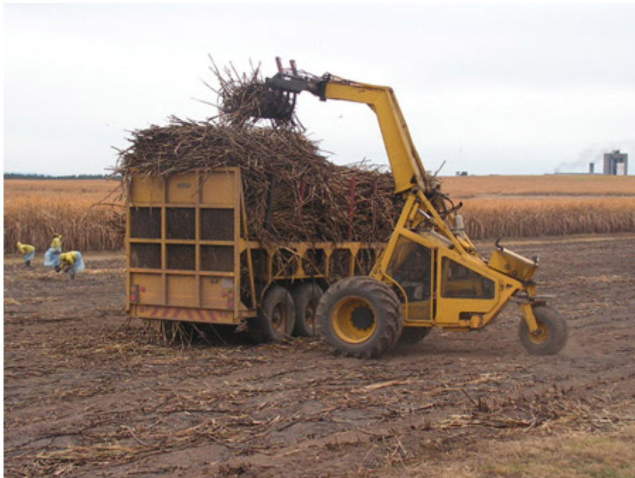
Système manuel A : chargement d'une remorque dans la parcelle grâce au BELL.
