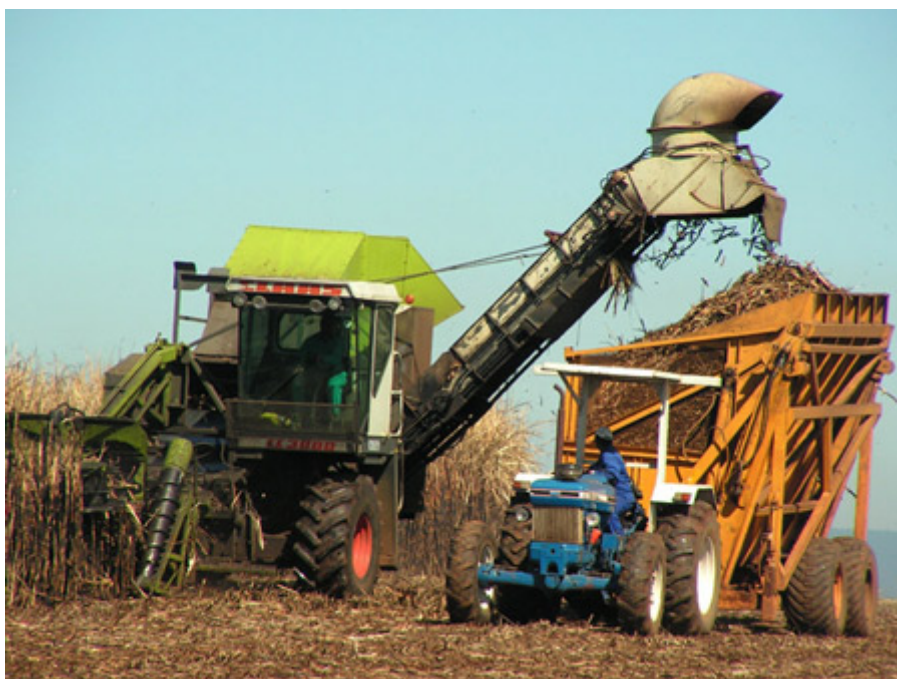
Coupe mécanique avec machine CLAAS et remorque élévatrice.
