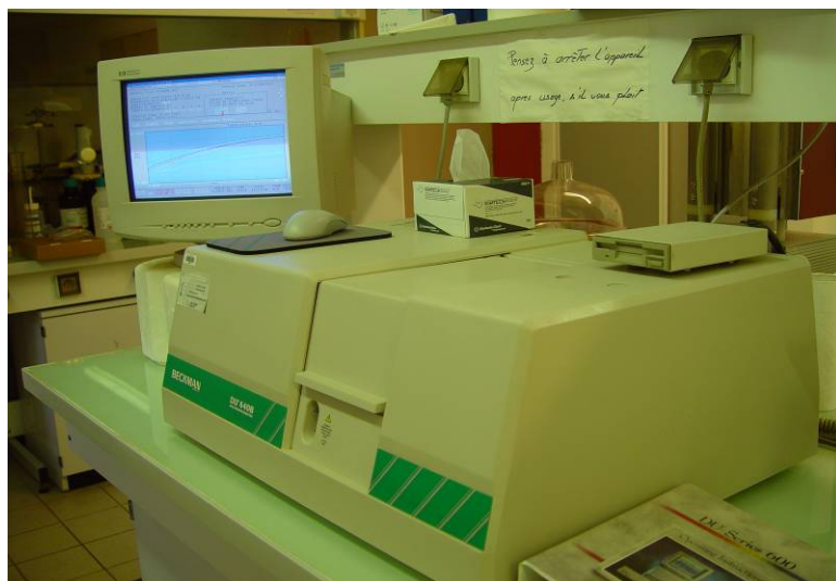
Figure 11 : Photographie du dispositif (spectrophotométrique) utilisé pour la lecture de l'absorbance (à replacer au bon endroit)
