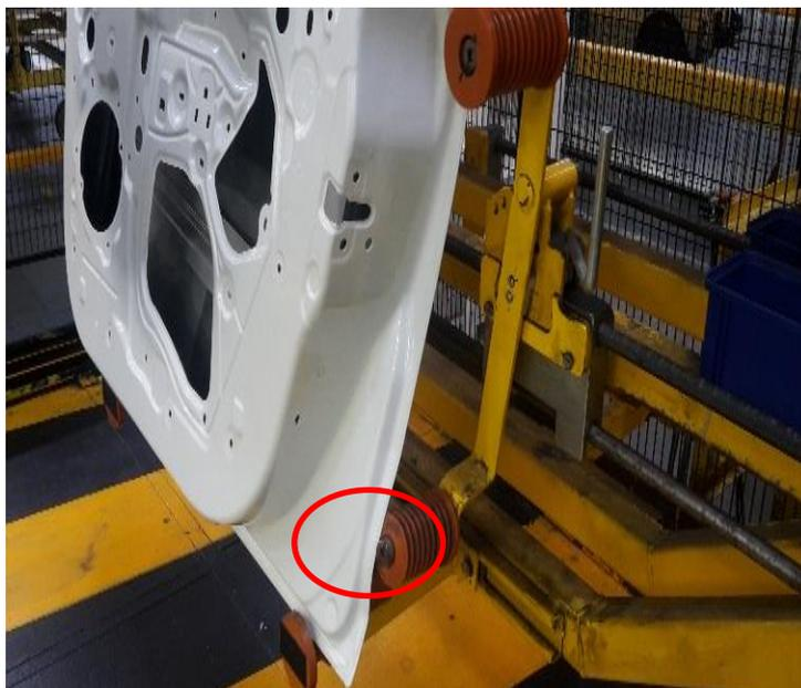
Figure 30: Exemple de diabolo dégradé
