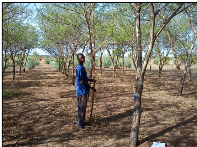
Photo 6 : Perche tenue par un assistant pour la mesure de la hauteur
