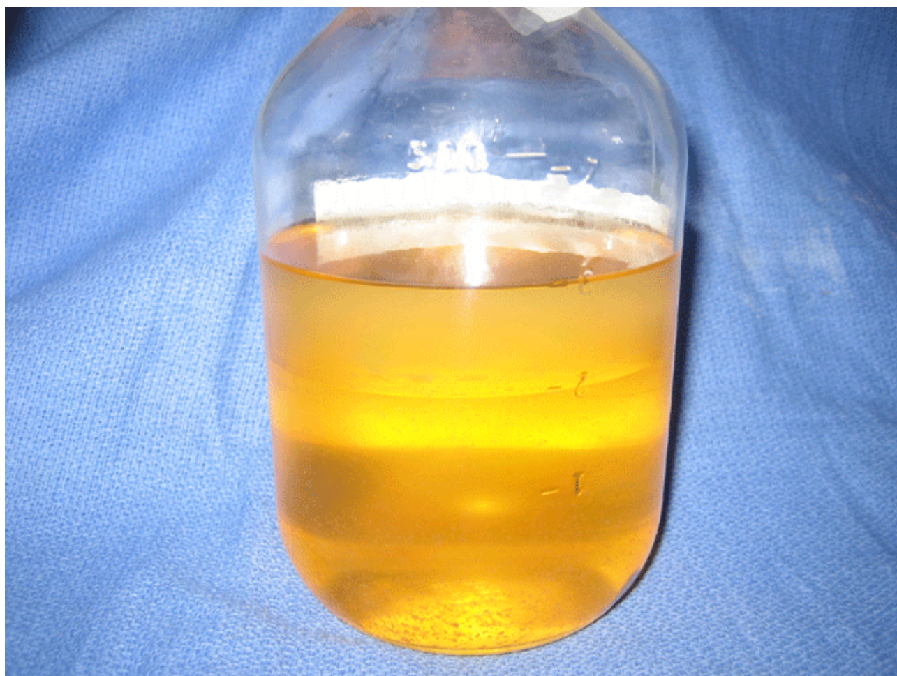
Fig.2 : Solvant récupéré après dégraissage par Soxhlet
