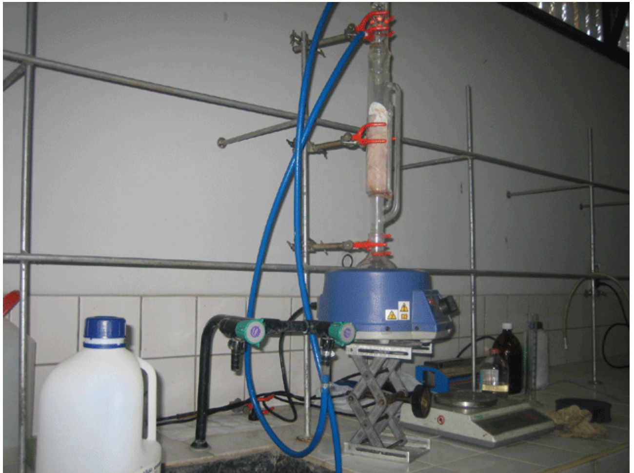
Fig. 3 : Les fragments osseux sont enveloppés d'un tissu et mis dans l'appareil d'extraction Soxhlet (Faculté des Sciences et Techniques – Marrakech)
