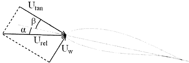
Figure 3.9 : Vitesses du vent au niveau d'un profil de pale [16]
