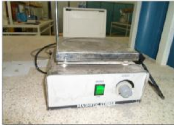
Figure IV.6 : Photo de l'agitateur (laboratoire de TEE du Département d'Hydraulique, université Abou Bakr Belkaid Tlemcen).
