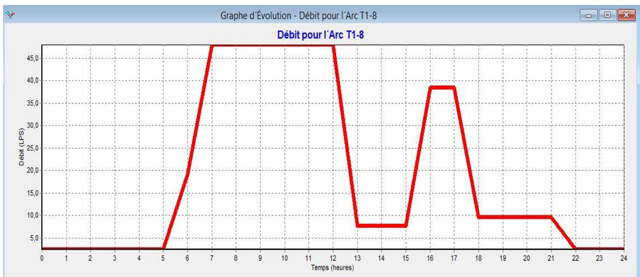
Figure IV.13 : Exemple de répartition des débits pour un tronçons dans le réseau d'AEP.
