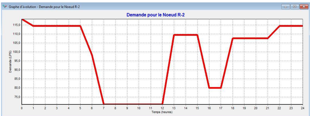
Figure IV.33 : Variation du débit au niveau du réservoir de Sidi Aissa.
