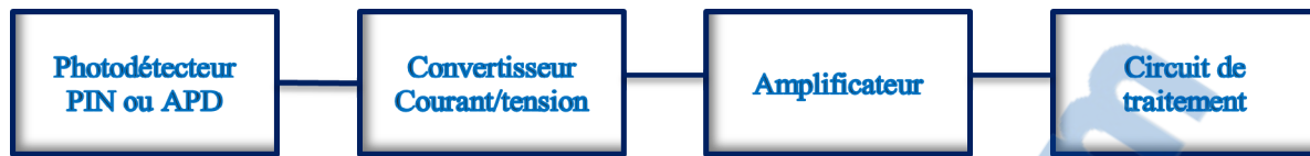
Figure I.12 : Schéma bloc d'un récepteur optique
