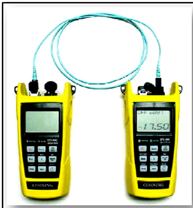
Figure IV.27 : Tests par un émetteur et un récepteur
