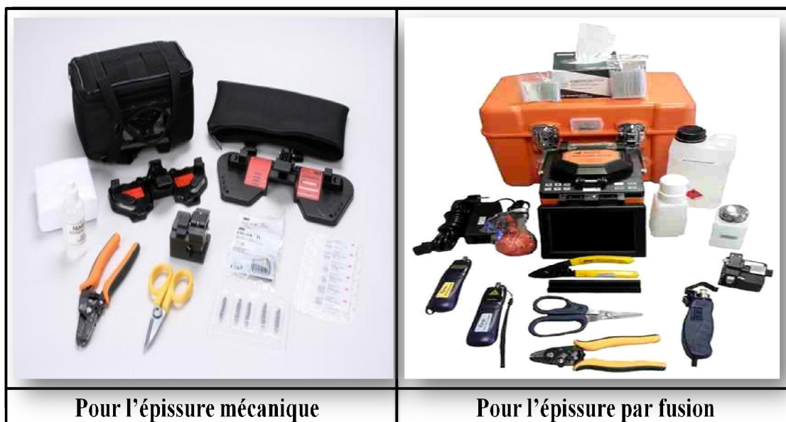
Figure IV.2 : Kit de raccordement par épissure
