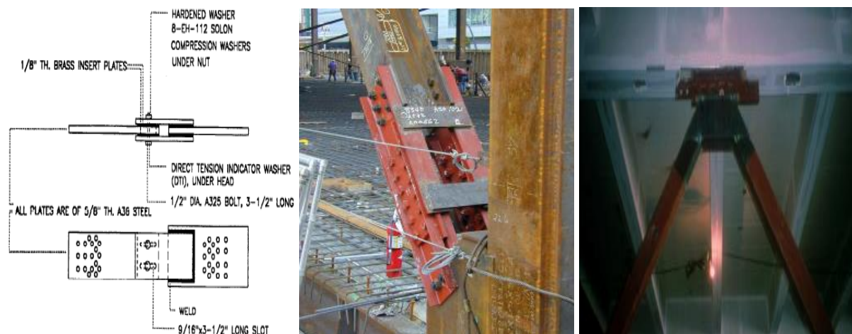
Figure 4.23 : Amortisseur boulonné encoché [6, 190]
