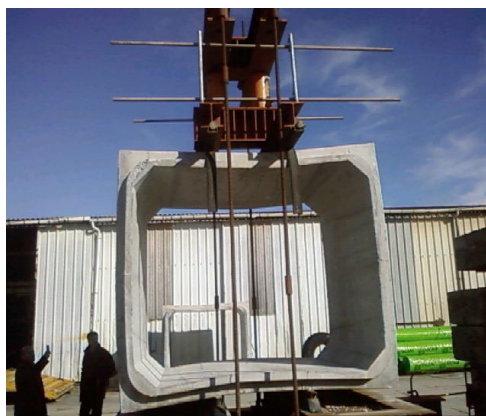
Figure 4.1 Essai in situ d'un OA préfabriqué
