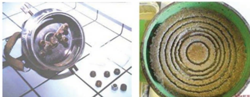
Figure 2.4 : Appareillage d'érodimètre à jets mobiles.
