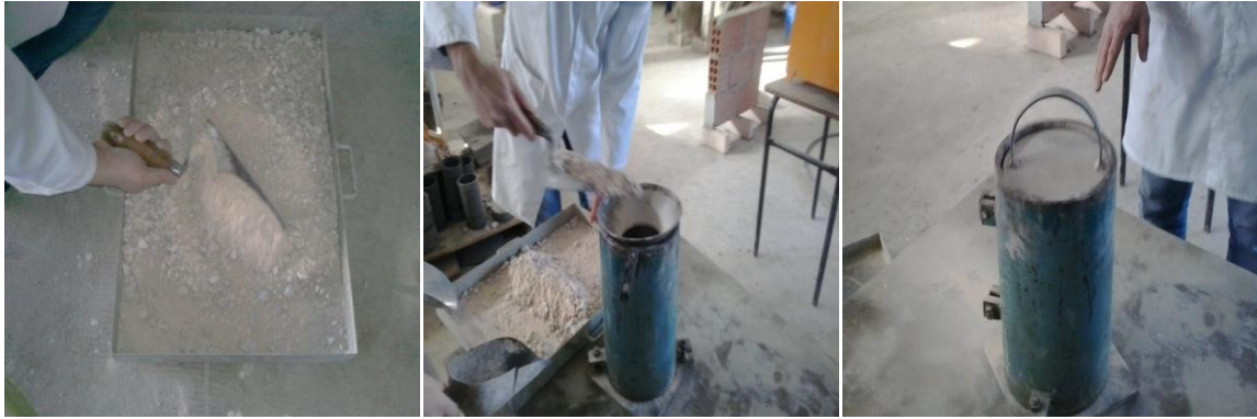
Figure 4.1. Mode opératoire pour l'essai de compacité.
