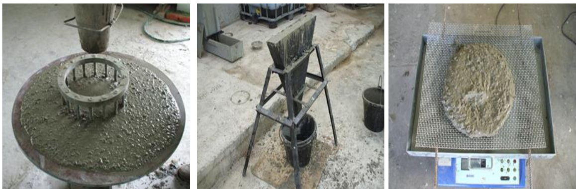
Figure 4.8. Les essais réalisés pour la caractérisation des BAP à l'état frais.
