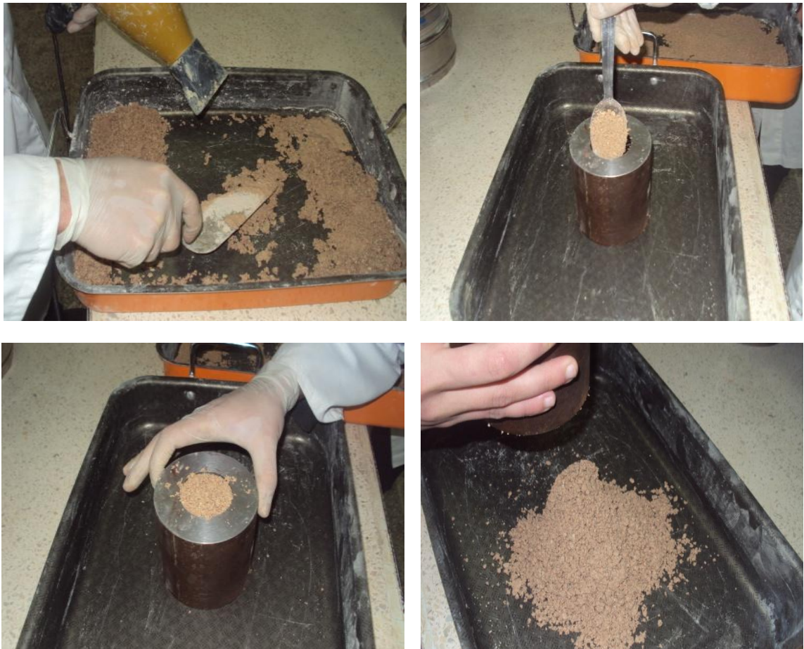
Figure 3.1. Les étapes pour la détermination du coefficient d'absorption du sable.
