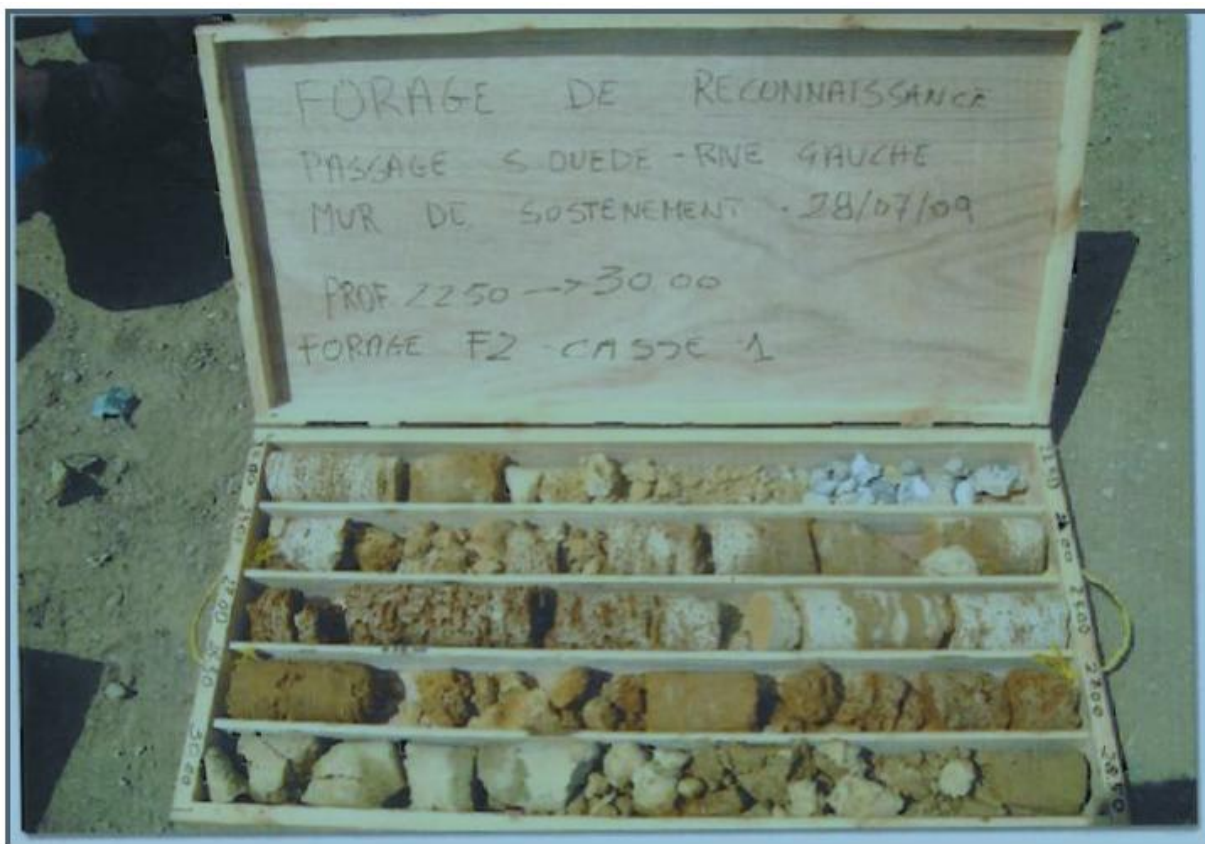
Figure I.16 : Échantillons issus des essais Carottés. (Omrani K et Boutria H, 2012)
