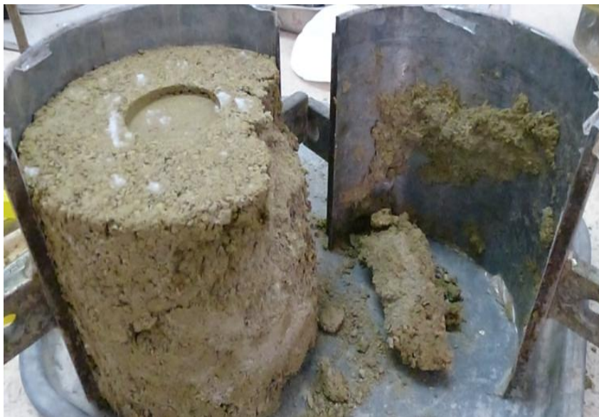
Figure III. 3: Compactage dynamique à l'aide du compacteur automatique. Et la figure III.4 montre clairement l'efficacité de l'utilisation de l'huile pour le démoulage.
