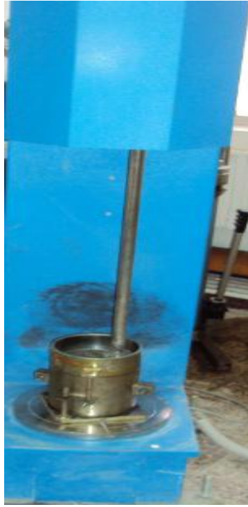
Figure III. 2: Compactage dynamique à l'aide du compacteur automatique.
