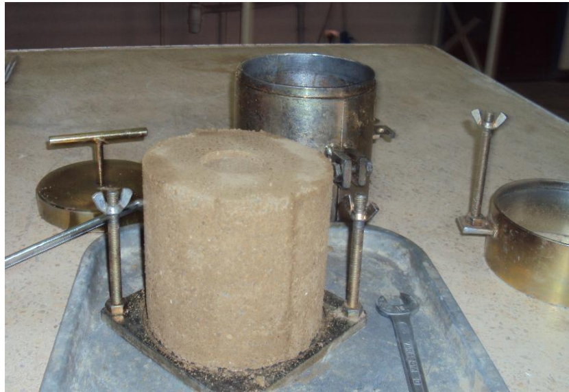
Figure III. 4:Le démoulage d'un échantillon compacté après l'utilisation de l'huile.
