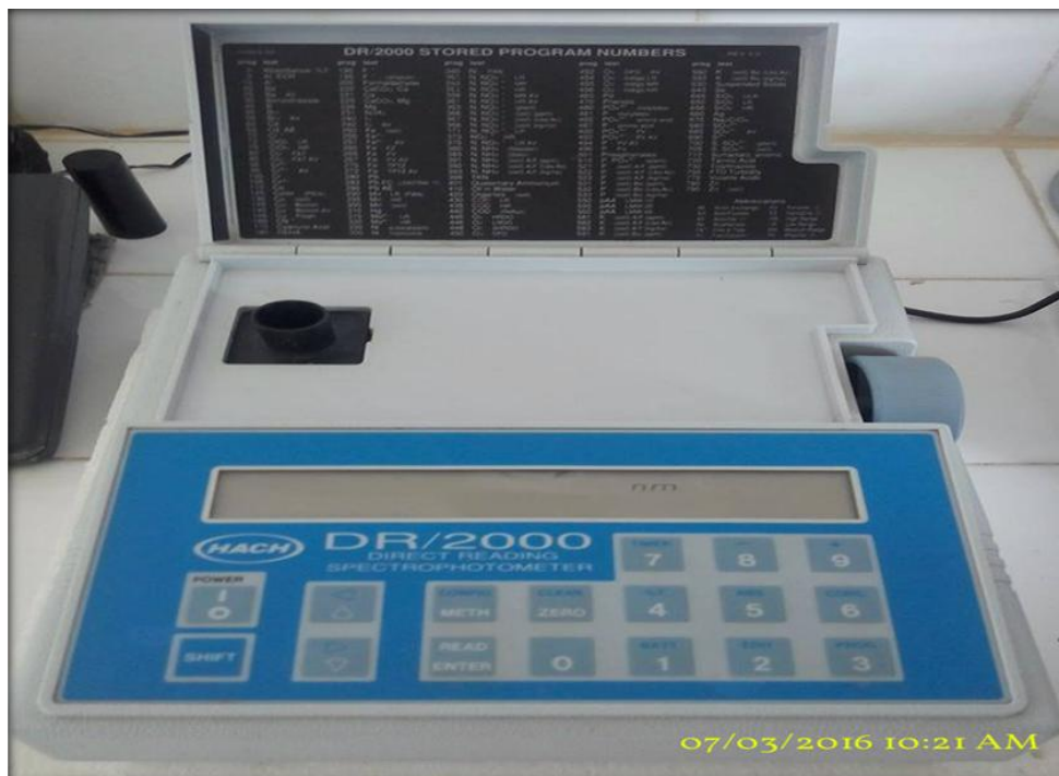
Figure IV.7: Photo du spectrophotomètre HACH DR/2000
