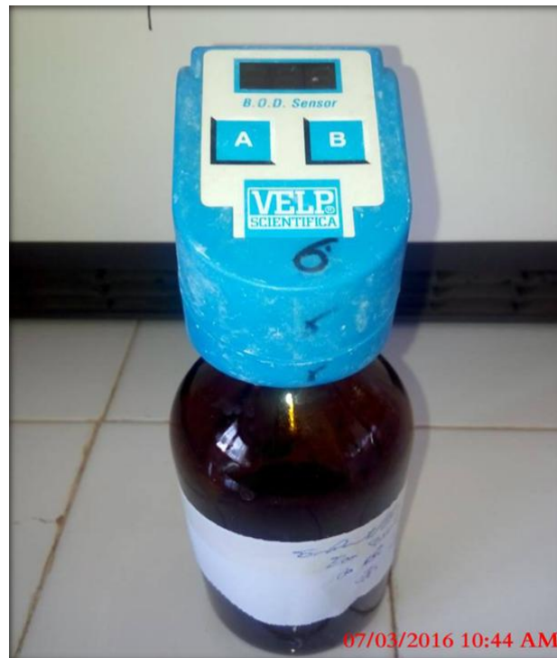
Figure IV.5 : Photo du flacon à D.B.O avec oxytope
