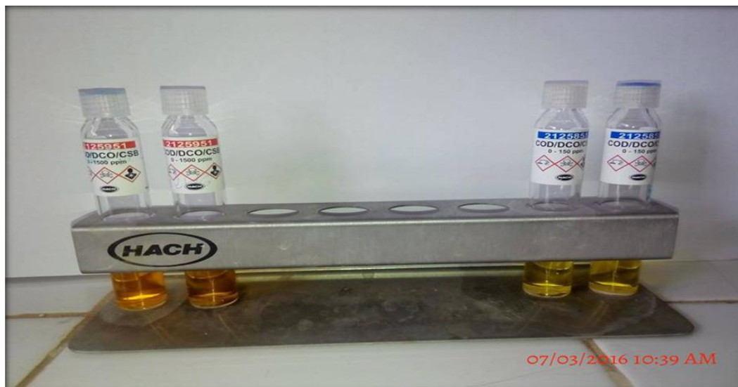
Figure IV.8: Photo des réactifs de la D.C.O
