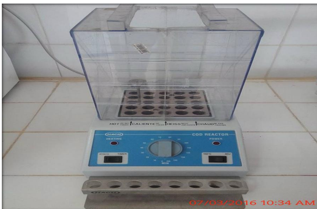
Figure IV.9: Photo du réacteur d'oxydation de la D.C.O (HACH)
