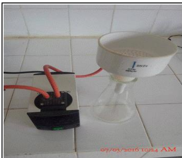
Figure IV.3: Dispositif de filtration sous vide (Pioneer TM)
