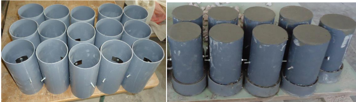
Figure 3. 13 – Moules 11x22 cm en PVC pour la confection des éprouvettes de béton.
