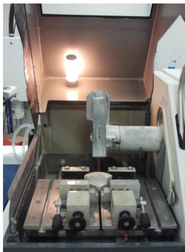
Figure 3. 20 – Scie électrique servant à découper les échantillons cubiques (Laboratoire Gem).
