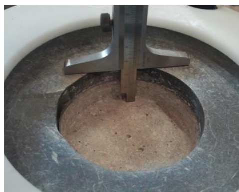
Figure 3. 34 – Mesure de la profondeur du Grignotage
