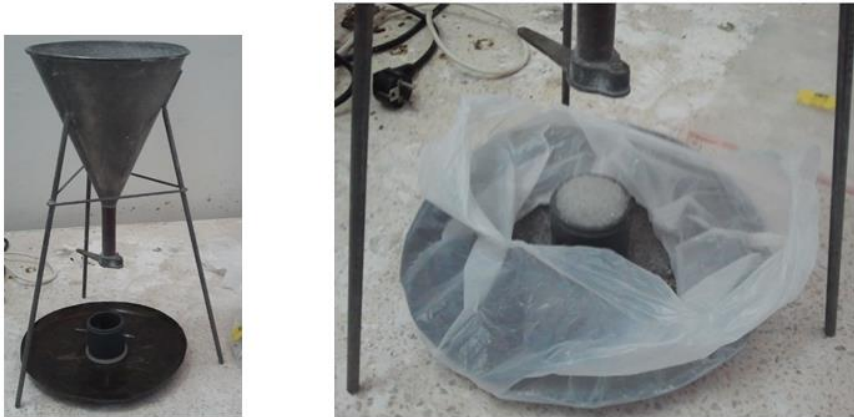
Figure 3. 16 – Méthode de remplissage de la cellule.
