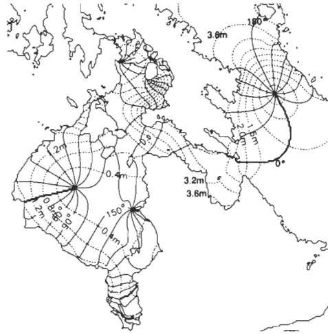
FIG. 4.1 – Lignes de coamplitude (m) et de cophase ( ^{\circ} TUC) superposées pour le mode normal de période 14,6 h.
