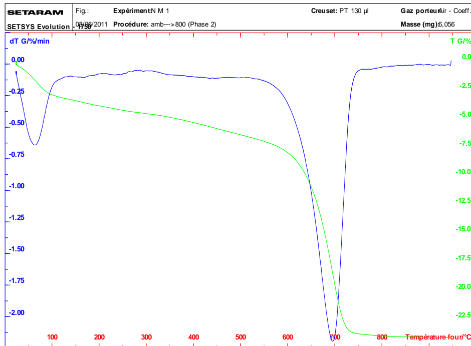
Figure 24 : la Température en fonction de ATD et ATG pour MY1
