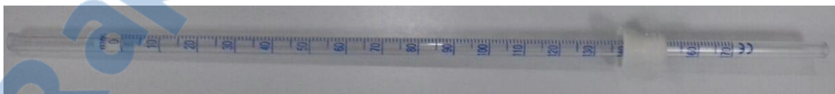
Figure.8 : Tube de Westergren. Il consiste à une pipette graduée de 0 à 170 mm avec bouchon blanc en caoutchouc pour remise à zéro automatique
