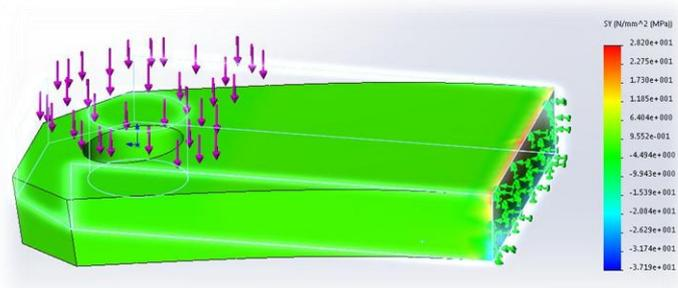
Pour cette analyse statique j'ai décidé d'appliquer une force nettement supérieure au poids de l'enceinte grillagée. Ensuite j'ai fixé la partie droite, celle qui est en contact avec le poteau, où on viendra appliquer une soudure pour assurer le maintien. Dans la
