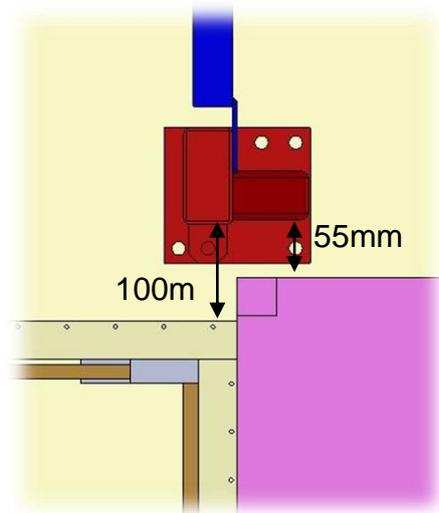
Sur l'image d'à côté, on peut voir le pied de la nouvelle adaptation de l'ancienne enceinte en rouge, et en beige la nouvelle proposée par BMI Axellent, notre fournisseur. La distance entre le poteau et le nouveau grillage est de 100mm.
