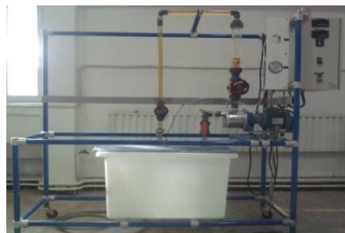
Fig.4.1: Banc d'essai d'une pompe centrifuge [21].
