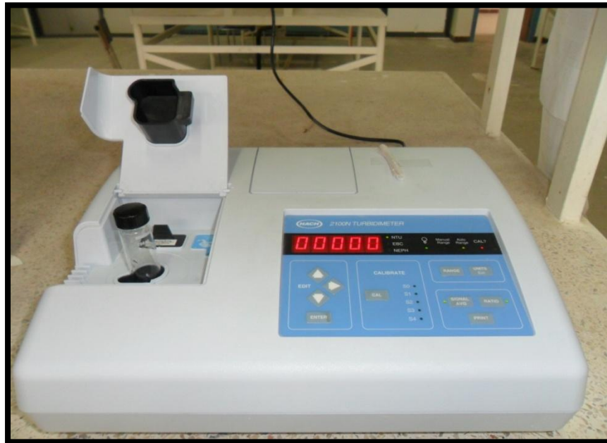
Photos N°3 : Le turbidimètre. (Laboratoire du Département d'Hydraulique. Université de Tlemcen)
