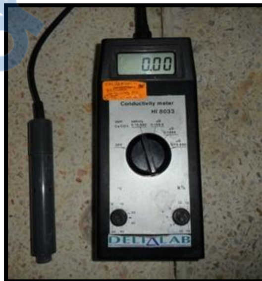
Photos N°4: Le conductimètre/ Salinomètre (laboratoire du Département d'Hydraulique. Université de Tlemcen)
