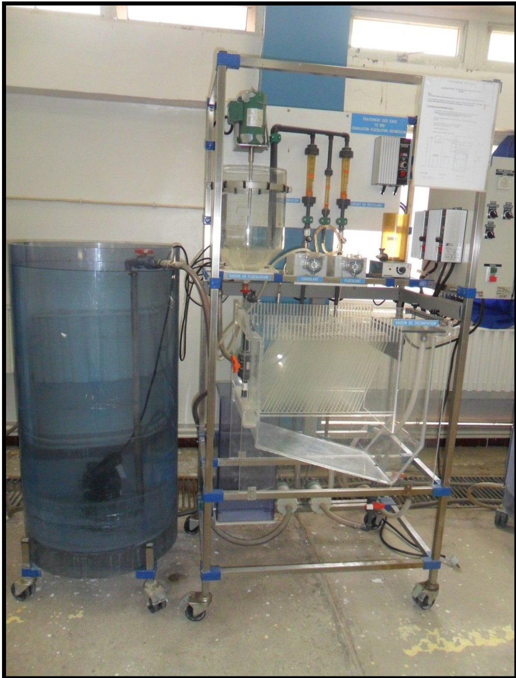
Photos N°1: Pilote de coagulation-floculation et décantation (TE 600) (laboratoire du Département d'Hydraulique. Université de Tlemcen)
