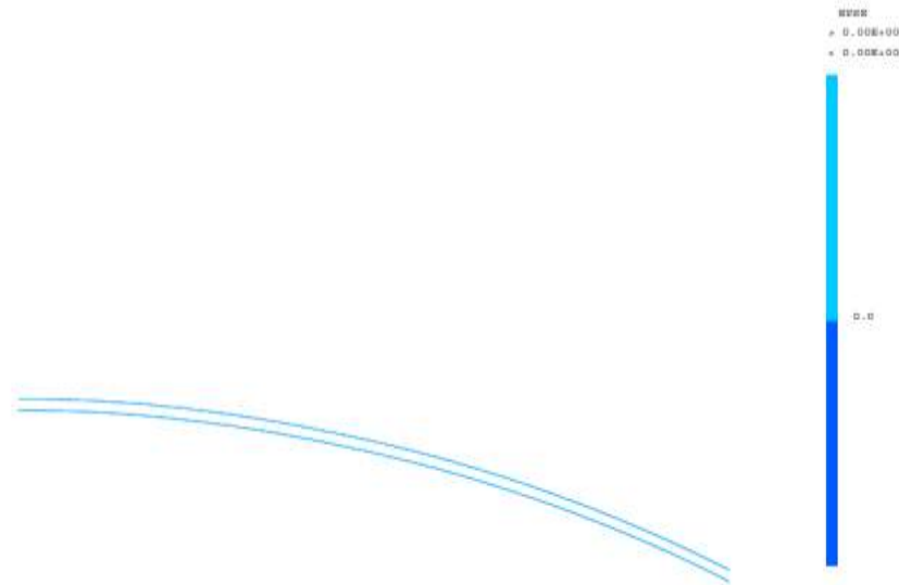
Figure4.8 : Déformation sous l'effet d'impact de l'avion Cessna 210
