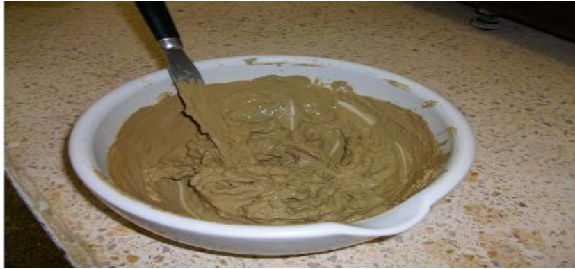
Photo 2.11 : Préparation de l'échantillon du sol soumis à l'essai de la limite de retrait voisine de la limite de liquidité W_L .
