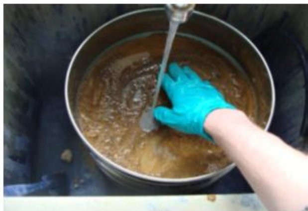
Photo 2.7 : Lavage du sol analysé au tamis de 80µm
