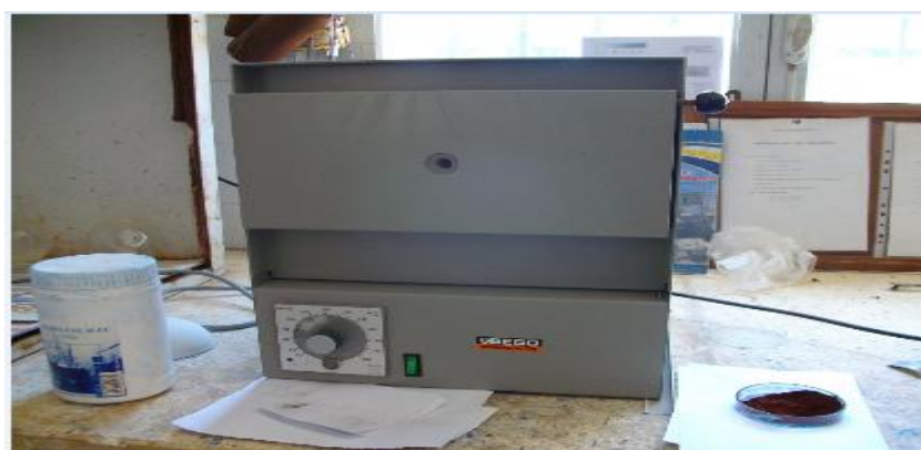
Photo 2.14: Four de calcination pour détermination de la teneur en matière organique
