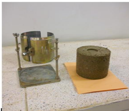
Moule CBR (Démoulage de l'échantillon)
