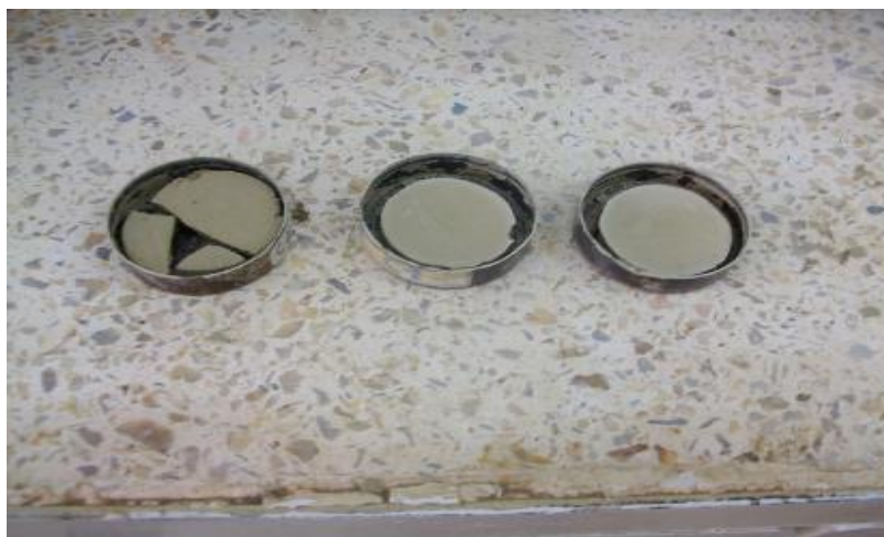
Photo 2.12 : Moule pour essai limite de retrait
