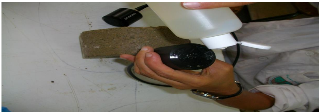
Photo 2.4 : Procédure de mesure Ultrasonique « en appliquant le couplant sur les transducteurs et les deux extrémités de notre échantillon à tester ».
