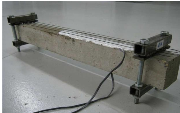
Figure 3.11 : Vue d'une poutre en béton équipée de quatre fils en AMF.
