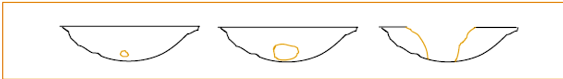
Figure 2.10 : Évolution d'un renard dans le corps de l'ouvrage. Vue en coupe rive/rive. (BONELLI, 2001)
