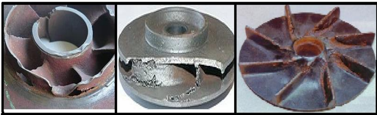
Figure II.30: Problème de cavitation
