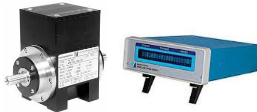
Figure 34 Image du couplemètre et de son électronique [9]
