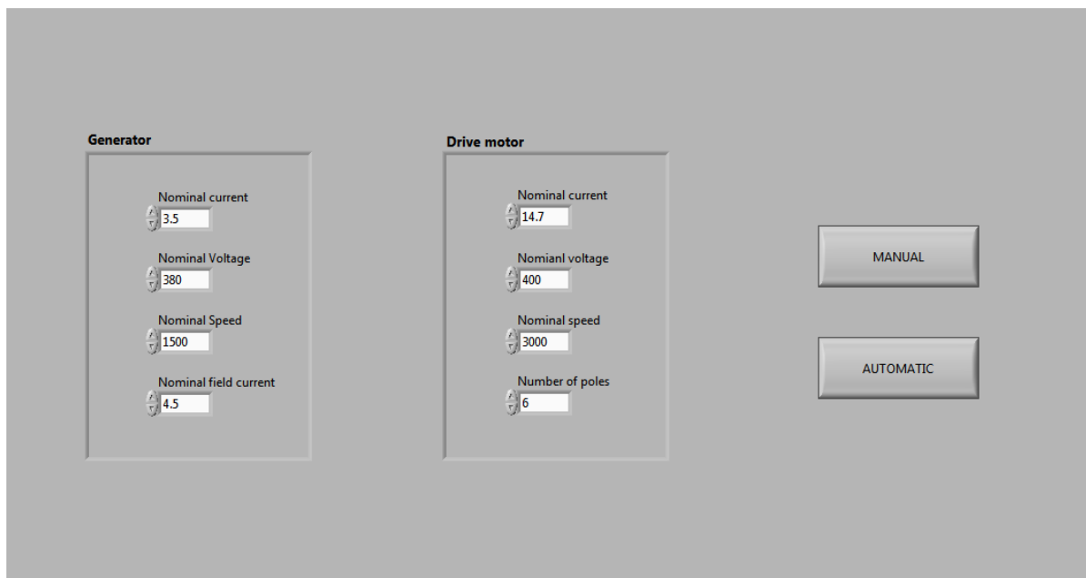
Figure 7 Caractéristiques du moteur d'entraînement et de la génératrice
