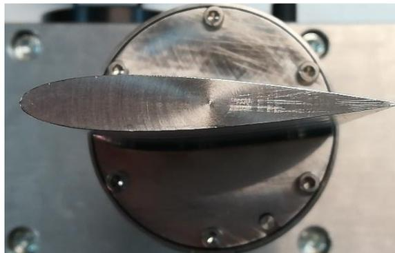
Figure 13: Profil NACA0015 utilisé pour les mesures
