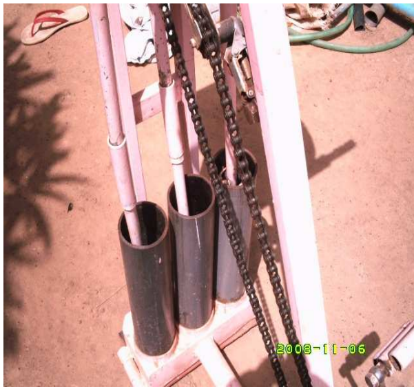
Les trois cylindres en tube PVC pour éliminer le temps-mort
