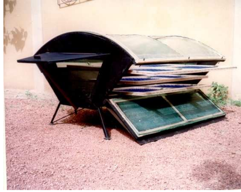
Séchoir solaire à tunnel du CEAS-BF
