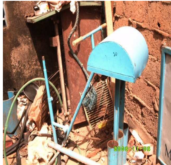
Un prototype de PPV à tiges courtes et cylindres métalliques mis au rebut
