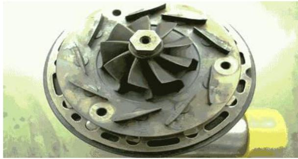
Figure III.10 : Turbo à géométrie variable
