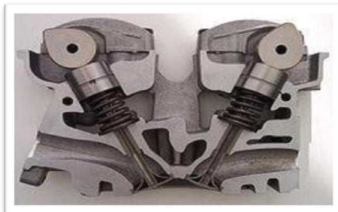
Figure II.14 : Les soupapes
